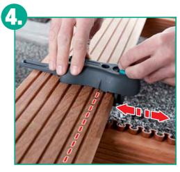
Coloque el **soporte de columna móvil** sobre la tarima y sitúe el casquillo de taladrar trasero exactamente sobre la línea marcadora correspondiente con ayuda de la muesca lateral.
