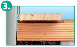
Instale entonces la tarima con los ensambles acortados a ras con el paramento de la casa. Entre el paramento y el canto de la tarima permanece de esta manera un espacio libre de 1 cm y la tarima puede atornillarse a través del agujero trasero con un tornillo y en la parte delantera con dos tornillos a la viga de soporte.
