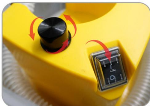
4 Interruptor ON /OFF y Regulador de caudal de aire para ajustar el volumen de aire deseado según la viscosidad del producto y la velocidad de aplicación.
