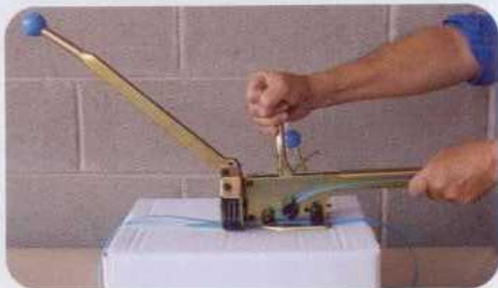
El otro extremo del fleje introducirlo por el cortador (nº 53 y por el tambor tensor nº 8 y tensar el fleje con la palanca nº 4.
