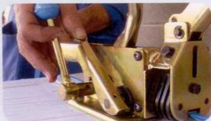
Levantar la palanca 205 y bajar la palanca de corte nº 3.
