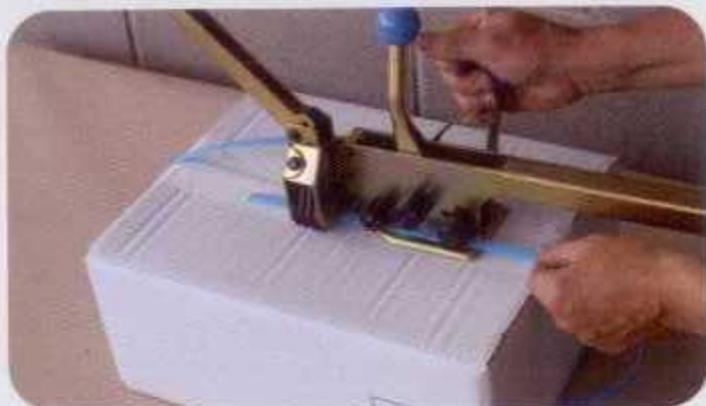
Colocar el fleje alrededor del paquete, sujetando la punta, con la palanca nº 205.
