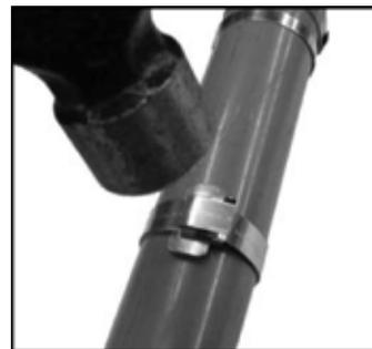
8. Con un martillo cierre las orejas de la hebilla para sujetar el remanente de la cinta en su lugar y así completar una abrazadera BAND-IT.
