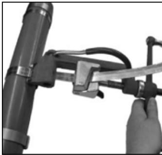
5. Doble la cinta girando la herramienta sobre la hebilla, regresando la manija de tensión cuando se esté llevando a cabo la operación del giro. Si no hace el retroceso de la manija de tensión de la herramienta a lo largo del proceso de doblar hacia la hebilla se puede causar que se rompa la cinta. No hay pérdida de tensión en la sujeción ya que la liberación de la cinta se usa para facilitar el doblar del fleje y el giro hacia arriba de la herramienta.
