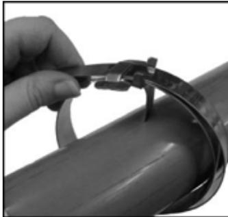
2. Continúe con una vuelta más al objeto a sujetar y páselo a través de la hebilla nuevamente. *Una sujeción con doble vuelta desarrolla una mayor compresión radial que con una sola vuelta. Doble el extremo de la cinta del lado de la hebilla debajo de ésta como se muestra.*
