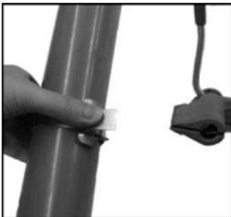
7. Quite la herramienta sujetando la cinta remanente hacia abajo con el dedo como se muestra.
