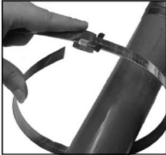
1. La cinta se puede usar directamente del rollo ya que esto elimina el desperdicio de la misma. Deslice la hebilla en la cinta como se indica. Lleve el otro extremo de la cinta alrededor del elemento a sujetar y tráigalo nuevamente a través de la hebilla.
