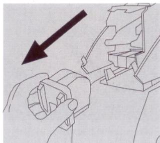
**Carga fácil.** Para sacar el cartucho vacío, levantar la visera protectora, agarrar el cartucho como en la figura y tirar de él.
