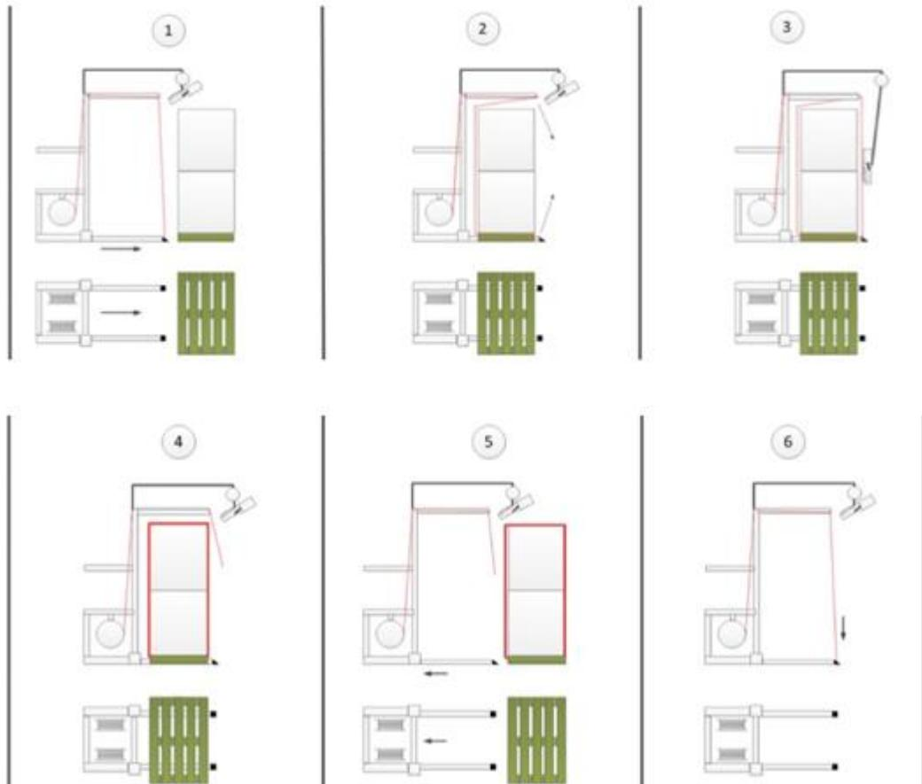
Lanza Flejes con flejadora de fricción incorporada y compensada con contrapeso.
