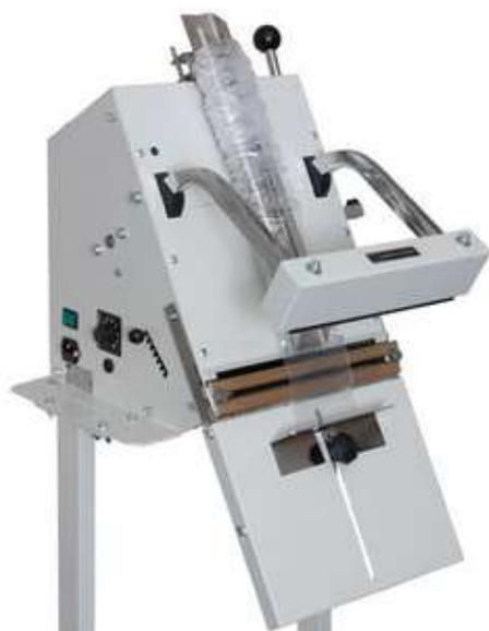
La Speedpack es una envasadora y selladora manual que funciona con tubo de polietileno enrollado en el canal de llenado. Al insertar los productos por el canal, el producto desciende por su propio peso, arrastrando el material tubular consigo. Una vez que el producto ha llegado al fondo de la bolsa, se puede iniciar el ciclo de sellado bajando el brazo de la máquina. El tiempo de sellado se regula con un temporizador. Un piloto luminoso se enciende mientras dura el impulso de calor programado.
