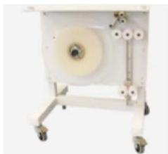
Mesa portabobinas, regulable en altura, para usar bobinas de hasta 1.000 mts
