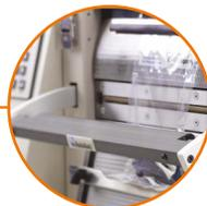
El área de carga abierta y la barra controlada del sellador maximizan la flexibilidad de carga y la seguridad del operador
