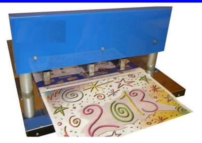
Grapadora neumática con tres cabezales para el grapado de faldillas de calendario.
