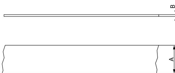
Es una abrazadera ideal para realizar sujeciones múltiples y de diferentes diámetros, aporta una fijación segura e inviolable y resiste los ambientes corrosivos y húmedos ya que está fabricada en acero inoxidable AISI 304. Se presenta en rollos de cinta de 50 m, espesor de 0,4 mm y 4 anchos de banda diferentes (de 9,5 mm a 19 mm). Su fijación se realiza con unas hebillas que se adaptan a las medidas de la cinta y con una llave especial que tensa y corta.
