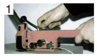
Se rodea la mercancía o el pallet con el fleje de polipropileno. La punta del fleje es necesario situarla entre la base y la escuadra de sujeción, asomando por debajo de la boca de cierre. Una vez colocado el fleje, se aprieta la palanca.
