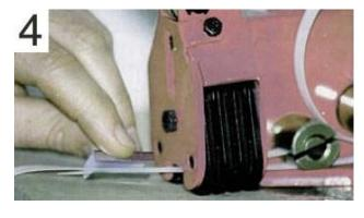
Introduciremos el precinto en el interior de la boca de cierre, sujetando el fleje. Después, volveremos a tensar el fleje como hicimos en el paso 3. Hasta el punto que estimemos adecuado.
