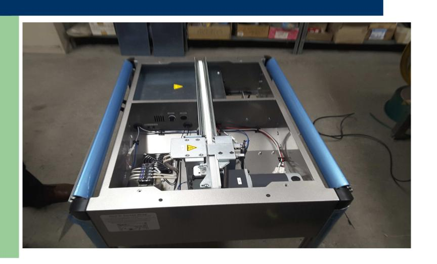
■ La iQ-400 Para desmontar las partes frecuentes no es necesaria ninguna herramienta, de esta manera se facilita el mantenimiento y limpieza por parte del operario.
