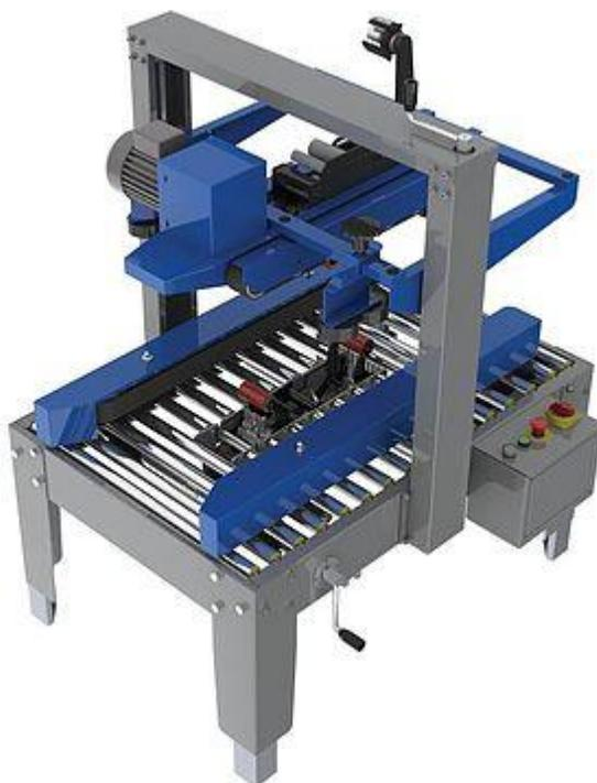
Esta precintadora está equipada con motorización superior y lateral e inferior. Las cintas transportadoras motorizadas regulables en anchura y altura aseguran un tránsito suave de las cajas que evita el riesgo de vuelco. Las unidades de cierre de esta precintadora son robustas y fáciles de ajustar.
