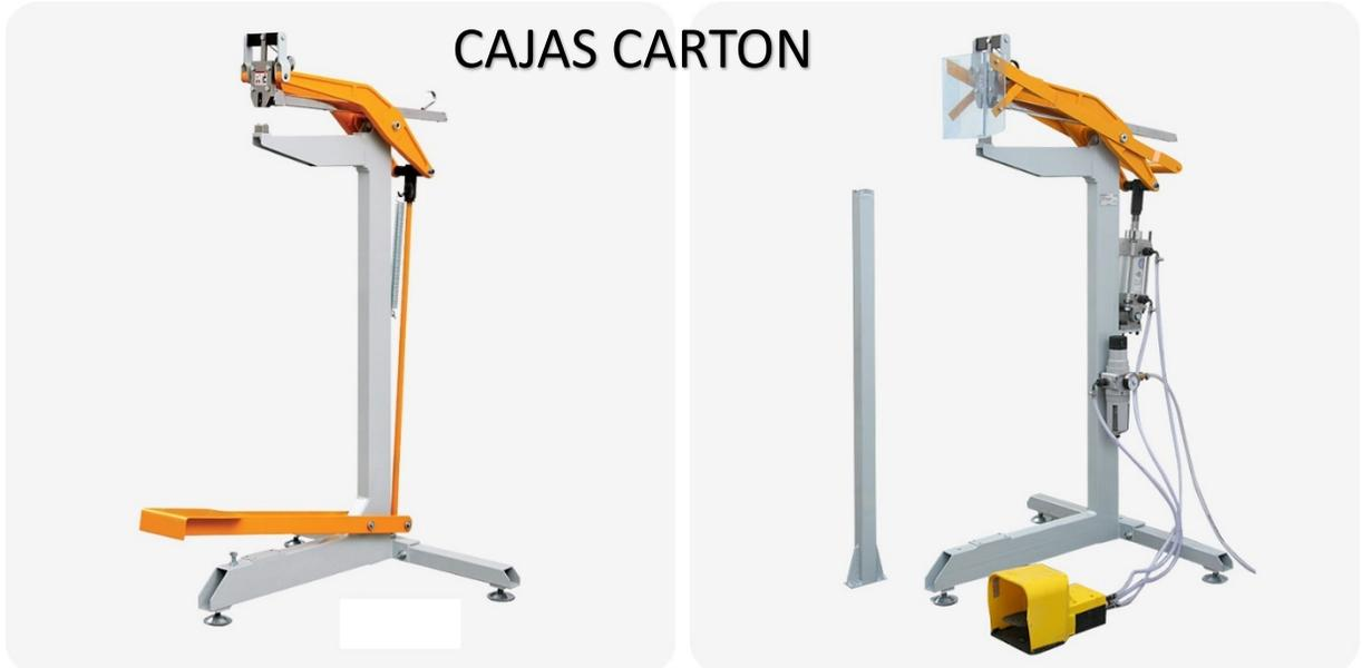
GRAPADORAS ESTACIONARIAS: brindan mayor eficiencia porque son operadas por una palanca de pie o una válvula neumática que permite al operador usar ambas manos al formar la bandeja
